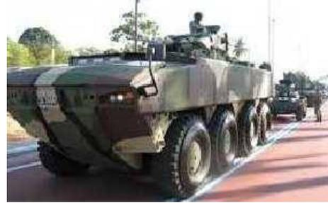
Большинство Gempita, входящие в батальон, будут оснащены башней с 25-мм пушками Bushmaster. Среди остальных машин, которые будут эксплуатироваться 19-м полком, будут варианты машин командования и управления, восстановления и инженерная машина.
