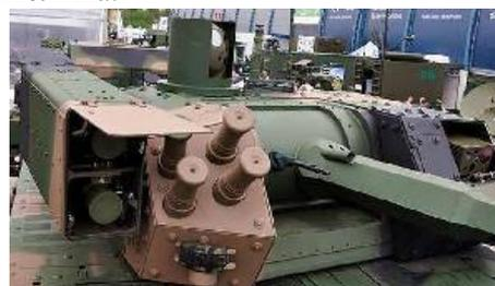
Концепция новой польской башни польского блока предполагает ее полную взаимозаменяемость с башней HITFIST-30P, т.е. новая ZSSW-30 должна устанавливаться на колесные боевые машины Rosomak без каких-либо изменений в корпусе. Обе башни имеют одинаковые погон и вращающееся контактное устройство. Кроме того, различия в распределении масс обеих систем будут
