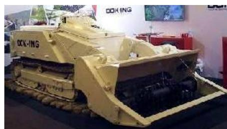
Во время выставки Exprodefensa 2015, которая прошла в Колумбии, хорватская компания DOK-ING представила один из своих наиболее популярных продуктов - робот для разминирования MV-4. MV-4 - система разминирования, полностью самостоятельно разработанная и изготовленная частной хорватской компанией DOK-ING.
