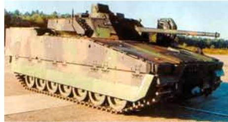
Комплект защиты от поражения сверху устанавливается на верхние поверхности CV9035NL, включая крышу башни, и обеспечивает повышенную защиту от поражения сверху, от таких видов оружия, как артиллерия и доставляемые ракетой бомблеты.
