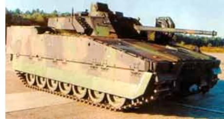
Комплект защиты от поражения сверху устанавливается на верхние поверхности CV9035NL, включая крышу башни, и обеспечивает повышенную защиту от поражения сверху, от таких видов оружия, как артиллерия и доставляемые ракетой бомбеты.
