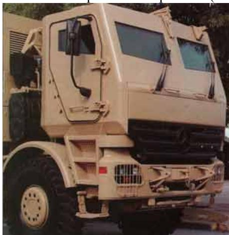
Немецкой армии необходимо закупить около 20 EADS, производства компании TransProtec – бронированного контейнера для перевозки 18 человек, который может быть установлен на шасси SX, производства MAN. Съемный контейнер TransProtec создавался для перевозки людей в районах с повышенной опасностью.
