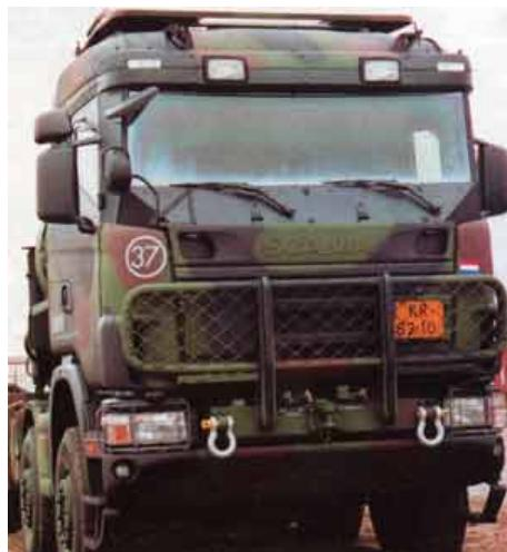
Компания Scania удачно справилась с задачей оснащения броней гражданского автомобиля. Она продала около 90 комплектов баллистической и противоминной защиты для грузовиков собственного производства, которые используются в шведской армии.
