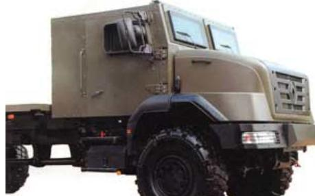
Альтернативой накладной броне стали съемные кабины для грузовиков. Этот подход использует компания Renault Truck Defense, которая поставила 20 съемных кабин по контракту на поставку 110 тяжелых тягачей Sisu E-Tech. Финская компания Sisu сейчас занимается поставкой около 80 грузовиков 8x8 в Литву и 9 мостоукладчиков 10x10 для финской армии; все эти машины оборудованы кабиной с баллистической защитой в базовой комплектации.
