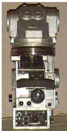
Тепловизионный прицел (или попросту – тепловизор) является прицелом, основанным на использовании теплового излучения объектов с целью получить изображение этих объектов. Для этого необходимо, чтобы температура объекта отличалась от окружающей его среды. Тепловизор улавливает тепловое излучение объектов и преобразует их в электрические сигналы, позволяющие создать изображение.
