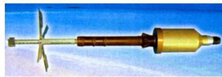
Ракета с хвостовым оперением для стабилизации полета, известная под обозначением WPF 2004 имеет стартовый вес порядка 3,2 кг и приводится в состояние боевой готовности на расстоянии 35-50 м от пусковой установки. Начальная скорость ракеты составляет 89 м/с, эффективная дальность поражения – 200 м при стрельбе по цели размером 0,45 м x 0,45 м.
