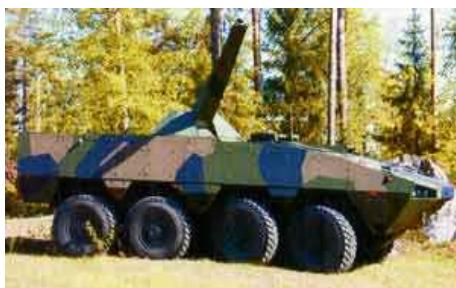
Финская компания Patria Weapon Systems уже почти завершила разработку 120 мм гладкоствольной башенной минометной системы NEMO (NEw MOrtar), которая впервые была продемонстрирована в середине 2006 года.
