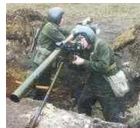
Безоткатное орудие — орудие, не имеющее отката при стрельбе. Данный эффект достигается за счет отвода части пороховых газов через специальное сопло в казенной части ствола, в результате чего создается реактивная сила, уравновешивающая силу отдачи.
