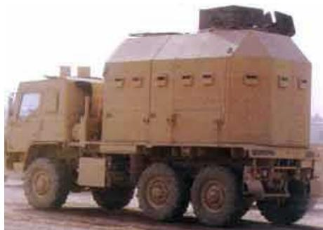
В Ираке военный транспортный автомобиль с вооружением (военный грузовик, оснащенный броней и несколькими пулеметами) применялся широко. Однако с учетом иракского опыта разработано новое вооружение и оборудование, которые за считанные часы позволяют придать машинам увеличенную броневую защиту и огневую мощь.
