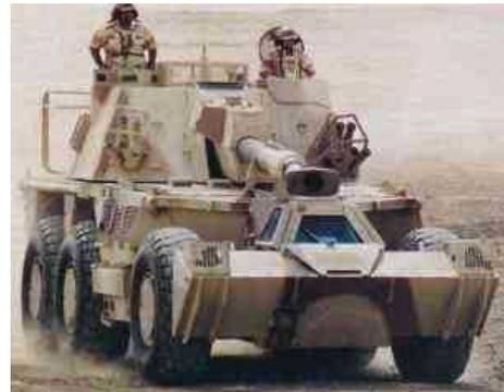
Помимо своего танка Olifant (модернизированный Центурион), ЮАР имеет на вооружении колесный парк ББМ. Для обеспечения огневой поддержки фирма Denel Land Systems разработала 155-мм самоходную артиллерийскую систему G6 на базе боевой машины с колесной формулой 6x6.
