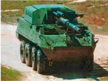
На этапе опытного образца совместными усилиями двух фирм разработана 105-мм самоходная артиллерийская система, установленная на шасси легкой бронированной машины (LAV III) с колесной формулой 8x8.
