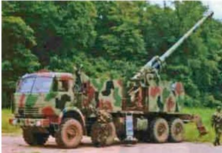
Одной из новейших колесных самоходных артиллерийских систем является 155-мм самоходная пушка NORA B-52. Первые ее образцы базировались на шасси грузовой машины FAR 2882 с колесной формулой 8x8.
