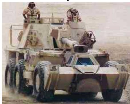
Помимо своего танка Olifant (модернизированный Центурион), ЮАР имеет на вооружении колесный парк ББМ. Для обеспечения огневой поддержки фирма Denel Land Systems разработала 155-мм самоходную артиллерийскую систему G6 на базе боевой машины с колесной формулой 6x6.
