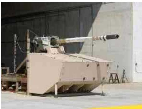
22 января 2009 г. Проведены испытания облегченной 120-мм пушки XM-360 для боевых систем будущего (FCS).
