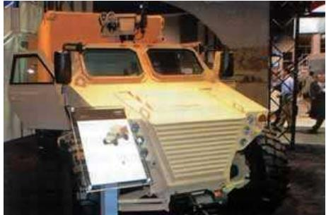
Опытный образец боевой тактической машины производства фирмы Lockheed Martin массой 9500 кг предназначен для движения в условиях бездорожья. Машина отвечает трем главным требованиям: защита, полезная нагрузка и надежная эксплуатация. Она имеет мощную пневматическую подвеску и V-образный корпус. Фирма Lockheed Martin сотрудничает с фирмой BAE Systems по проблемам повышения живучести и противоминных средств защиты.
