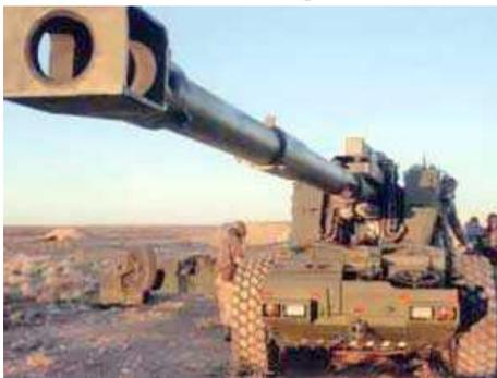
Система Condor разработана фирмой Denel Land Systems для экспорта и состоит из шасси машины-вездехода Татра с колесной формулой 8x8. На шасси установлена прицепная артиллерийская система G5-2000, вооруженная 155-мм пушкой 52 калибра.
