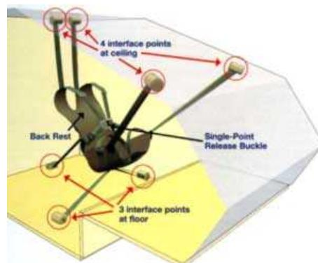
Такие сидения предлагаются фирмой Autoflug. В данном случае отсутствует жесткое соединение между сидениями для десанта и корпусом. Сидения закреплены к корпусу ремнями из плотной ткани, причем для механика-водителя 4 ремня крепятся к крыше, а три - к полу. Такие сидения используются на новом германском БМП Puma и установлены на некоторых канадских машинах Leopard.
