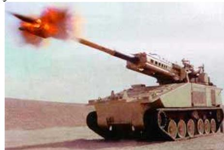
Экипаж NLOS-C P1 состоит из двух человек, система оснащена 155мм/38 калибровым артиллерийским орудием с автоматической системой загрузки снарядов, которая сначала загружает снаряд, а затем MCS.
