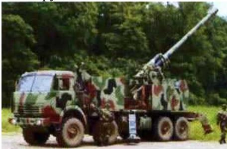
155мм/52 калибров орудие установлено на поворотной платформе в тыльной части шасси; во время езды ствол закрепляется в передней части системы, а во время огня орудие стреляет с тыльной части. Боекомплект состоит из 36 снарядов и соответствующего числа модулей заряда, максимальная дальность полета снаряда ER FB BB на данный момент составляет 44 км.
