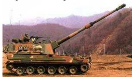
K 9 имеет боевой вес 46,3 тонны и стандартную дальность полета 155-миллиметрового снаряда M 107 HE - 18 км, которую можно увеличить до 40 км, использовав снаряд HE BV.
