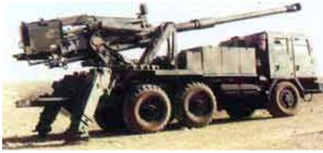
ATMOS может быть установлена на любые шасси, кабина управления находится в передней части системы, орудие устанавливается в задней. Максимальная дальность полета снаряда зависит от сочетания снаряд/заряд, в среднем составляет 41 км.
