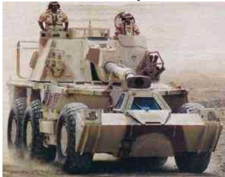
Результатом дальнейших разработок, проведенных Denel Land Systems, стала 155мм/52 калибров артиллерийская самоходная система \_G6-52, которая базируется на модернизированном шасси, имеет новую башенную систему со встроенной автоматической системой заряжания 155-миллиметровых снарядов. Это способствует высокой скорострельности до 8 выстрелов за минуту. Башня имеет боекомплект из 40 155-миллиметровых снарядов, и дополнительно 8 155-миллиметровых выстрелов расположено в шасси.
