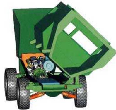
Машина Ocelot допускает передний угол въезда до 45°, а задний угол съезда - до 40°. Высота расположения кузова машины и положение трубы забора воздуха и выхлопа означают, что она может преодолевать брод глубиной до 800 мм.
