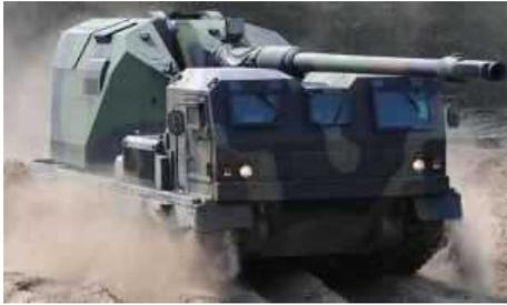
Немецкая армия на данный момент сняла с эксплуатации все 155-миллиметровые самоходные артиллерийские орудия M 109A3G, некоторые из которых были отправлены за границу. В частном порядке, компания Rheinmetall Weapons and Munitions провела модульную модернизацию M 109, получив M-109 L52, которая позволяет использовать всю номенклатуру боеприпасов 155 мм/52 калибра PhZ 2000. Ее выпустили на рынок как модульную систему, которую можно адаптировать к персональным пользовательским требованиям.
