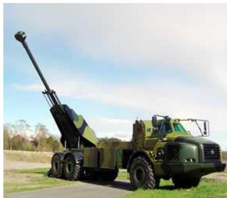
Archer базируется на вездеходном шасси 6x6 Volvo, имеет полностью защищенную кабину в передней части системы и 155мм/52 калибров орудие в тыльной части. Оружие управляется, наводится и запускается командой, находящейся в кабине.
