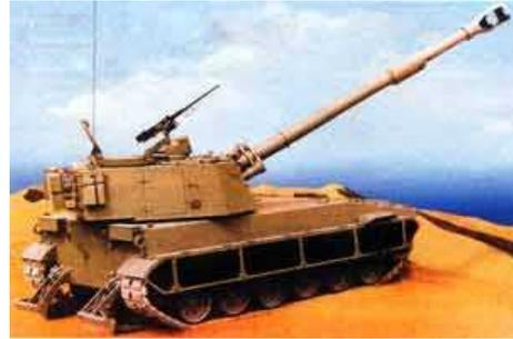
Япония также долгие годы разрабатывала свои собственные артиллерийские самоходные системы. Модернизированная старая модель Type 75 155мм – Type 99 имеет большую дальность полета, благодаря установке ствола 155мм/39 калибра. Как и многое другое японское оружие, Type 99 не была предложена на экспорт.
