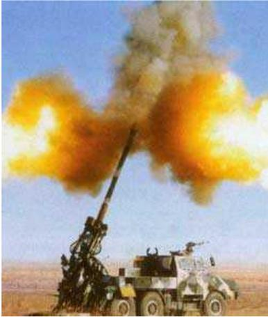
Наиболее мощная система – SH 1 (6 x 6) имеющая вездеходное шасси, защищенную кабину и артиллерийское орудие 155мм/52 калибра, установленное в корме. Машина управляется командой из 6 человек, имеет боевой вес в 22 тонны и максимальную скорость 90 км/ч.
