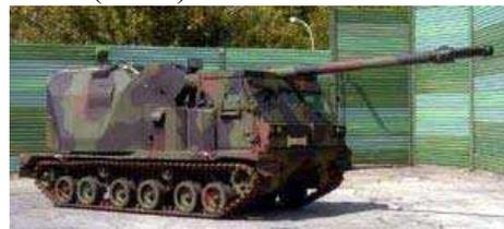
Первый AGM состоял из оставшегося гусеничного шасси реактивной системы залпового огня (MLRS) M 270, в корме которого расположена башня дистанционного управления, заряжаемая такими же зарядами 155мм/52 калибра как и в PhZ 2000. В передней части машины находится защищенная кабина, из которой команда управляет орудием.
