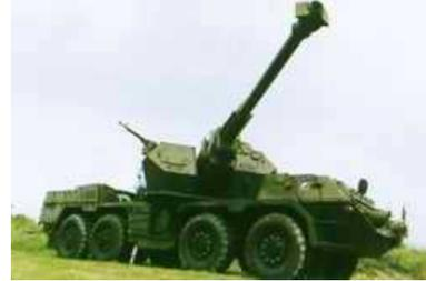
Дальнейшее развитие словацких самоходных орудий завершилось производством 155мм/45 калибров \_Zuzana, модернизированной во многих аспектах. Система базируется на вездеходном шасси серии Tatra 815, имеет защищенную кабину для команды в передней части системы, полностью закрытую башню в средней части и защищенный моторный отсек в тыльной части.
