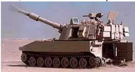
Новейшая версия – M\_109\_A6\_Paladin – оснащена 155 мм/39 калибровым артиллерийским орудием, новой башней и модернизированным шасси.
