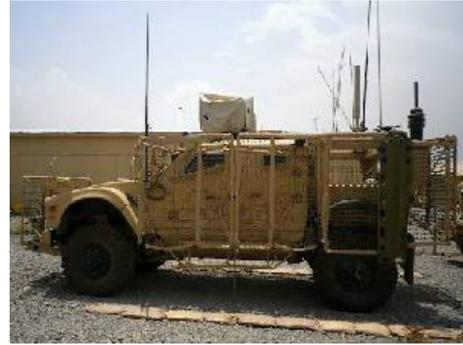
Сети обеспечивают дополнительную защиту от противотанкового оружия типа РПГ. Navistar ранее направила 970 комплектов RPG Net для семейства машин MaxxPro в поддержку операций в Афганистане. Новые комплекты будут установлены на машины MaxxPro эксплуатирующиеся на театре боевых действий. Поставки планируется начать в августе 2012 года и завершить к декабрю 2012 года.
