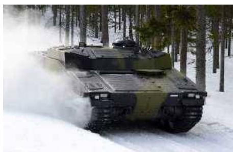
Armadillo (Броненосец) - это безбашенная версия боевой машины CV90 с баллистической и противоминной защитой, которая превышает требования Stanag 4a/b. Удаление башни дает дополнительных шесть тонн запаса по полезной нагрузке для размещения дополнительной защиты или для других целей, а современная электронная архитектура дает возможность применять новые системы plug-and-play.
