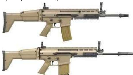
Штурмовая винтовка SCAR-L STD имеет камору под патрон калибра 5,56 x 45 мм НАТО и оснащена стандартным стволов 14,5 дюймов. Для ближнего боя стрелок может заменить стандартный ствол коротким 10-дюймовым стволов менее чем за пять минут, превратив оружие в вариант SCAR-L CQC. Для повышения огневой мощи на винтовку может крепиться подствольный гранатомет FN40GL-L.
