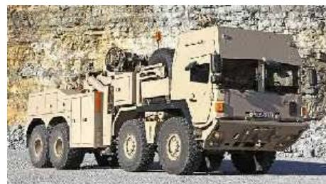
Тяжелая тактическая ремонтно-эвакуационная машина (HTRV - Heavy Tactical Recovery Vehicle) весом около 36 тонн базируется на испытанных и проверенных колесных шасси SX45 с колесной формулой 8x8 немецкого совместного предприятия Rheinmetall MAN Military Vehicles GmbH (RMMV). Оно сочетает высокие безопасность и комфорт экипажа с выдающейся маневренностью, будь то на дороге или на сложной пересеченной местности.
