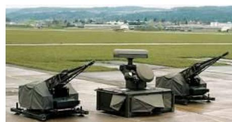
Немецкие ВВС официально приняли на вооружение свой зенитный комплекс Mantis C-Ram (Counter-Rocket, Artillery, Mortar), предназначенный для перехвата неуправляемых ракет, артиллерийских снарядов и мин. Комплекс создан компанией Rheinmetall.
