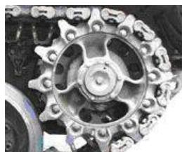
Ведущее колесо танка - составная часть гусеничного движителя, предназначенная для перематывания гусеничной ленты (гусеницы) и преобразования собственного вращательного движения в поступательное движение танка.
