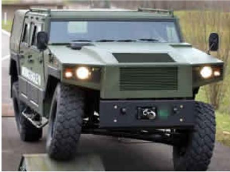
Предыдущие три модели серии Eagle производились на базе американского военного внедорожника Humvee. При проектировании четвертой швейцарцы предпочли разработать собственное шасси. В настоящее время шасси построено по схеме 4x4, но в перспективе конструкторы собираются создать вариант 6x6.
