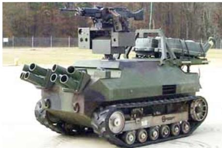
Боевой модуль SWARM с дистанционным управлением, разработанный британской фирмой Thales UK был выбран Корпусом Морской Пехоты США для установки на боевой робот, разрабатываемый по программе Gladiator.
