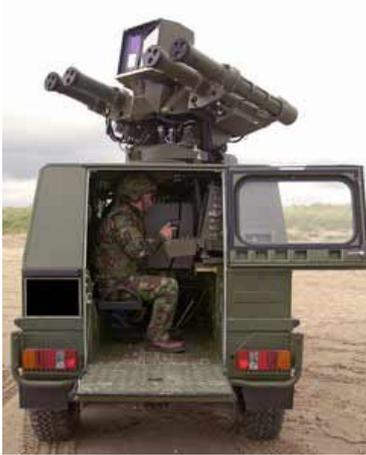
Thales UK на выставке DSEi продемонстрировала THOR – первую боевую систему такого типа. THOR представляет собой многоцелевой боевой модуль, монтируемый на наземные машины. Его основное преимущество – комбинация легких управляемых ракетных систем классов «земля-воздух» и «земля-земля».
