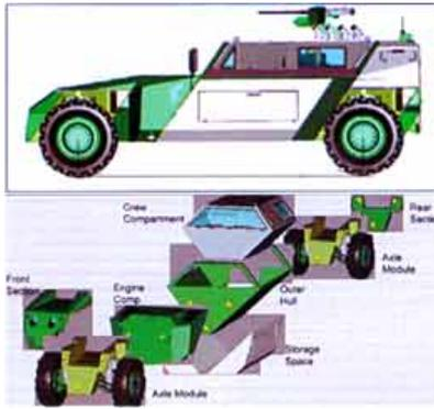
Разработчики собираются скомбинировать конструкцию противоминной защиты, учитывающую опыт Южной Африки с конструкцией «Citadel», которая концентрируется на максимальной защите экипажа. Как минимум один опытный образец с такой защитой уже был изготовлен. AVS будет иметь модульную конструкцию, базирующуюся на использовании электропривода с моторами, размещенными в ступицах колес.
