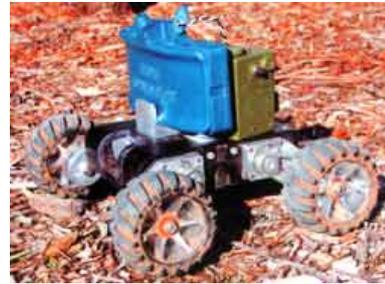
X-MUTS включает в себя самоходную платформу, приводимую в движение электромотором, питаемым от аккумуляторов. Она перемещается на четырех колесах повышенной проходимости. В дальнейшем, кроме варианта 4x4, может быть разработан вариант и 6x6, которая помимо большей грузоподъемности обеспечит лучшую стабильность и проходимость.
