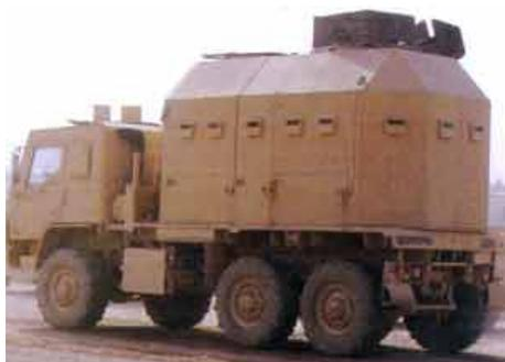
Teledyne Brown Engineering разработала вариант бронирования средних и тяжелых грузовиков, который предлагается Корпусу Морской Пехоты США для защиты от стрелкового оружия и осколков бомб.
