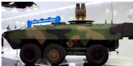
Новый колёсный истребитель танков 6x6 представлен PGZ в рамках Международной выставки оборонной промышленности MSPO 2017 в Польше. Машина оснащена новой башней с дистанционным управлением, вооруженной четырьмя пусковыми установками противотанковой управляемой ракеты большой дальности Spike NLOS.
