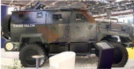
Ejder — это бронированная машина с колесной формулой 4x4, использующая V-образную конструкцию корпуса, в которой применены плавающие плиты днища и сидения с защитой от взрыва, что в совокупности обеспечивает высокий уровень защиты от мин и взрыва самодельных взрывных устройств. Ejder в турецкой армии оснащен одной открытой башенкой с круговым бронированием, вооруженной одним 12,7-мм тяжелым пулеметом.
