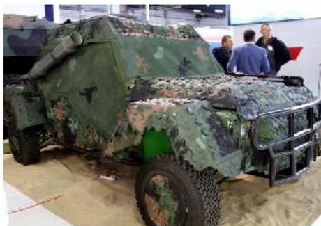
На выставке MSPO 2017 дочерняя компания PGZ демонстрирует на багги применение своей многозадачной интегрированной системы UAV-UTV управления БПЛА. Машина построена на решетчатой раме с защитным кожухом.
