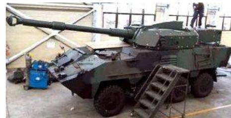
Индонезийская компания PT Pindad работает над новым легким колесным танком, боевой бронированной машиной, вооруженной 105-мм противотанковой пушкой.
