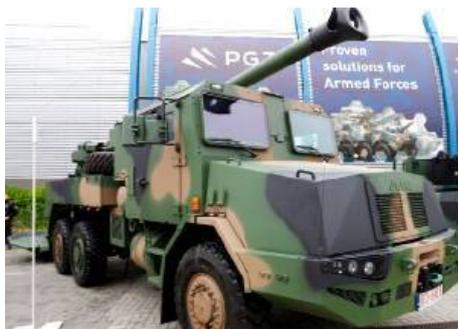
Во время выставки MSPO 2017 в Кельце польская компания Huta Stalowa Wola продемонстрировала опытный образец самоходной колесной гаубицы Kryl калибра 155 мм. После серии испытаний машина подверглась незначительным изменениям, и первый серийный образец может быть поставлен польской армии в начале 2019 года.
