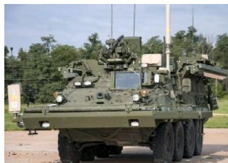
Представьте, что направленный взрыв настолько точен, что он может разрезать боеголовку за миллионную долю секунды, прежде чем она попадет в защищаемую машину. Это принцип работы Iron Curtain (Железный занавес), активной системы защиты, компьютерный мозг которой выполняет 50 000 вычислений за время, которое вам нужно, чтобы моргнуть.
