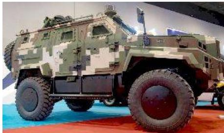
Официальные лица сообщили, что Ejder Yalcin подвергнется испытанию малайзийской армией после завершения выставки DSA 2018. Она оснащена дизельным двигателем Cummins мощностью 375 л.с., который обеспечивает максимальную скорость движения 120 км/ч.
