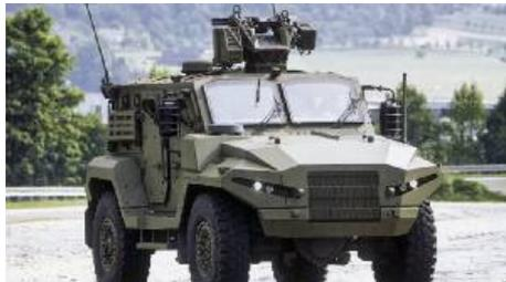
Excalibur Army, дочерняя компания чехословацкой группы, разработала бронированную машину Tatra T815 Patriot - также известную как Средняя бронированная тактическая многоцелевая машина MATMMV (Medium Armored Tactical Multi-Mission Vehicle). Первый образец этой машины, оснащенный боевым модулем с дистанционным управлением, установленным на крыше, в настоящее время проходит заводские испытания.
