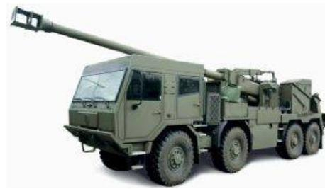
Чешская компания Excalibur Army представила свою новую самоходную автономную артиллерийскую систему с автоматической загрузкой боеприпасов, обеспечивающую эффективный огонь как прямой, так и не прямой наводкой. Ее конструкция базируется на 155-мм/52-кал самоходной гаубице Zuzana 2, от которой было использовано максимальное количество узлов и систем, проверенных во время сложных испытаний и тендеров, проведенных по всему миру.
