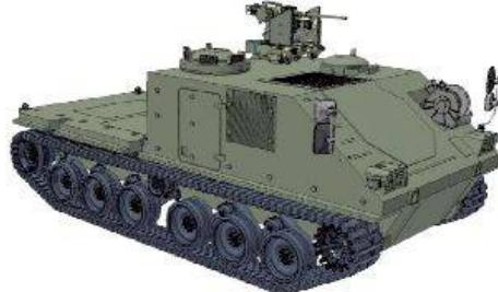
Первый образец ACSV будет иметь цельносварной корпус из алюминиевых броневых листов с дополнительным пакетом пассивной брони.
