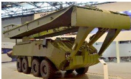
General Dynamics European Land Systems (GDELS) во время международной выставки Eurosatory 2018 представила свой новый мостоукладчик на шасси бронетранспортера Piranha IIIC 8x8. Мостоукладчик представляет собой Piranha IIIC, оснащенный Переменным складным мостом VFB (Variable Folding Bridge), разработанным и изготовленным британской компанией Pearson Engineering.
