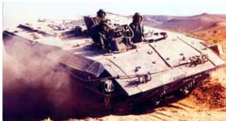
Более удачным решением стала тяжелая БМП Achzarit. Ее разработала в начале 80-х годов фирма NIMDA на базе танков Т-55, которых у Израиля скопилось большое количество после войны 1967 года. На вооружение эти БМП поступили с 1989 года. Машина получилась низко-профильная – высотой всего 2 метра. С танка была удалена башня и установлено более легкое вооружение. Была усиlena броня бортов и крыши корпуса.
