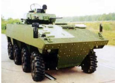
Примерно к 1990 г. французская армия приняла довольно амбициозную концепцию семейства восьмиколесных бронемашин, или VBM (Vehicles Blinde's Modulaires), массой 20-30 т. Базовый БТР VBM предназначался для транспортировки отделения десантников, но семейство должно включать и несколько вариантов, включая некоторые, вооруженные 45 мм пушками, а некоторые даже танковой пушкой калибра 120 мм.
