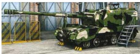
Китайская компания Norinco разработала новую самоходную 155 мм /52 калибра гаубицу (SPH), огневые испытания которой уже начались.
