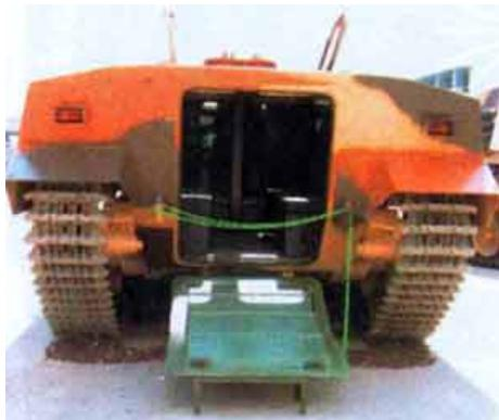
MAP были созданы совместно KADDB и южноафриканским Mechanology Design Bureau (MDB). В основном боевом танке Tariq (вариант британского танка Centurion) был изменен корпус и направление движения ведущих колес.
