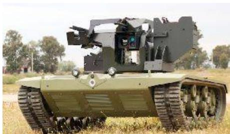
Платформа предлагает пользователю широкий спектр применения, она имеет боевой модуль тяжелым и легким вооружением, может служить машиной для разведки и наблюдения, транспортером для перевозки раненных и грузов, а также другие конфигурации.
