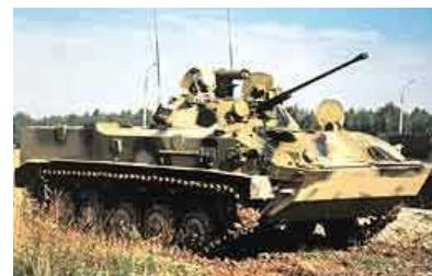
Боевая машина десанта (БМД) - боевая гусеничная плавающая машина, авиадесантируемая парашютным, парашютно-реактивным или посадочным способом. БМД предназначена для транспортировки личного состава воздушно-десантных войск, повышения его мобильности, вооружённости и защищённости на поле боя.
