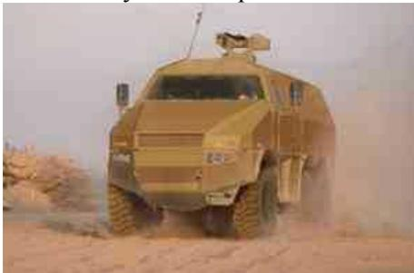
В Grizzly размещается 10 полностью экипированных солдат. KMW утверждает, что полезная нагрузка увеличилась «более чем на 50%» от требуемых в запросе на предложение 3 тонн. Кабина водителя и отделение экипажа образуют отсек безопасности, который защищает против СВУ, баллистической угрозы, снарядов и мин.
