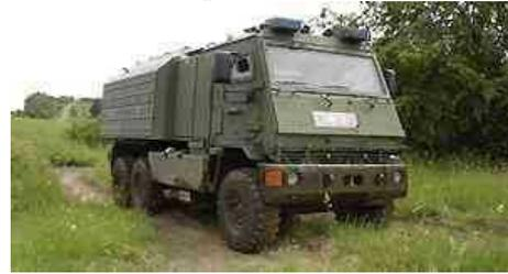
Rheimetall доработала броню Yak в последние месяцы, чтобы обеспечить защиту от СВУ. Первые 30 Yak, принятые на вооружение в 2005 и 2006 отвечали требованиям первой необходимости немецкой армии в Афганистане, обладали броневыми панелями, которые защищали против стрелкового оружия и противопехотных мин. Когда силы НАТО в Афганистане стали объектом атаки дорожных бомб и самоубийц-подрывников, армия расширила список требований к Yak, включив в них защищенность от СВУ.
