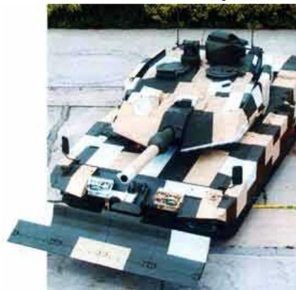
В середине 2006 г. фирма KMW продемонстрировала танк Leopard 2 PSO, который предназначен для использования в операциях, проводимых миротворческими силами. Образец танка разработан по собственной инициативе фирмы и базируется на модернизированном варианте танка Leopard 2A5. Модернизацию можно применить к вариантам танков Leopard 2A4 и Leopard 2A6, поскольку все они имеют электрическую систему управления пушкой.
