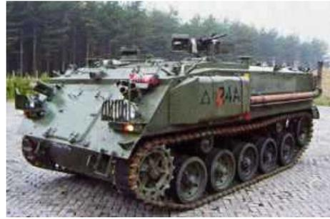
STAWS оснащен ПЗС камерой и тепловизором с широким и узким полем зрения. Регулировка в вертикальной и горизонтальной плоскостях осуществляется электроприводами, однако предусмотрены и стандартные ручные органы управления. Система может быть запрограммирована с учетом зон запрета огня, что обеспечивает меры безопасности для обслуживающего персонала.
