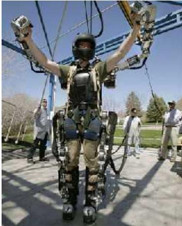
Экзоскелет представляет собой роботизированный механизм с сервомотором и гидравлическими приводами. Проведение первых полевых испытаний намечено на 2009 год. Пока что главной проблемой является малое (до 30 минут) время работы аккумуляторных батарей.
