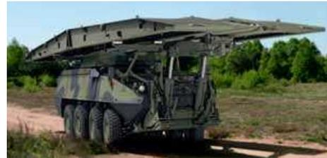
Функциональные возможности широко используемого бронетранспортера Piranha III с колесной формулой 8x8, выпускаемого фирмой MOWAG (Швейцария) еще больше расширились. Шасси БТР стало применяться для установки на нем мостоукладчика (AVLB).
