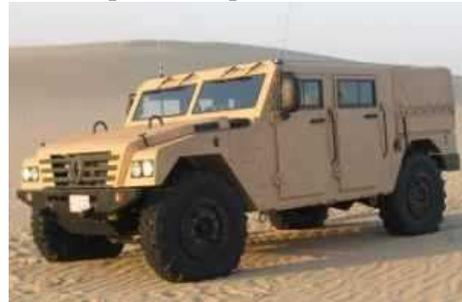
По результатам испытаний выбрана машина большой вместимости Sherpa 3A. Она пришла на замену устаревшего бронетранспортера Berliet VXB-170, который выпускался с 1973 г. В общей сложности на вооружение поступят 92 БТР Sherpa 3A. Они имеют бронированный по всей длине корпус.
