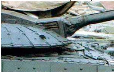
Известна другая конструкция защитного модуля, содержащего пять стальных/взрывающихся слоев, ориентированных под большим острым углом наклона в направлении летящей ракеты (750). Каждый из подрывных слоев связан с одним слоем, который уложен вдоль внутренней части корпуса брони. Когда удлиненный стержневой наконечник или струя кумулятивного снаряда ударяется о поверхность брони, происходит детонация этого взрывного слоя в модуле.
