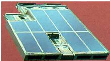
Последняя разработка Украины в области динамической защиты, известная как «НОЖ», выпускается Микротек. Утверждается, что модули «НОЖ» более эффективны (в 1,5- 2 раза), чем традиционные конструкции динамической защиты. Важным преимуществом данных модулей является возможность взаимной замены на элементы 4С20 и 4С22 российского производства.
