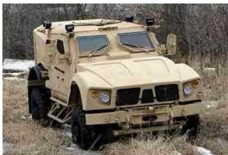
Фирма Oshkosh Defense, филиал фирмы Oshkosh Corp., сообщила, что разработанная ею MRAP повышенной проходимости (M-ATV) успешно прошла эксплуатационные испытания, преодолев более 3000 миль, включая более 1000 миль в условиях бездорожья.
