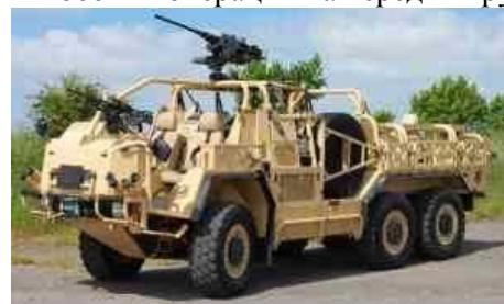
Машина Jackal 2 будет обладать двигателем объемом 6.7 литра. Он позволяет развить максимальную скорость по дороге около 129 км/час и по пересеченной местности - 89 км/час.
