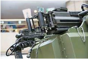
Боевой модуль с дистанционным управлением Т96 содержит экран для защиты боеприпасов от огнестрельного оружия, 40-мм автоматический гранатомет и 7,62-мм пулемет. Кроме того, отличительной особенностью этого боевого модуля является 16 единиц 66-мм гранатометных установок для пуска дымовых гранат, установленных с внешней стороны аналогично башенной системе.
