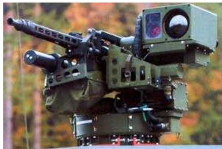
Боевой модуль FLW 100 может быть вооружен 5,56-мм пулеметом MG4 или 7,62-мм пулеметом MG3. Модуль FLW 200 также может быть вооружен станковым 12,7-мм пулеметом M2 HB или 40-мм автоматическим гранатометом производства фирмы Heckler & Koch. Без вооружения модуль FLW 100 весит порядка 80 кг, а масса модуля FLW 200 на 90 кг больше. Подобно большинству боевых модулей оба варианта стыкуются к корпусом при замене вооружения без труда, причем положения регулировок баллистики выставляются автоматически.
