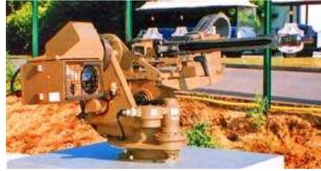
Вооружение последнего может быть различным - от оружия обычного стрелкового калибра до 40-мм автоматического гранатомета включительно. Масса модуля составляет 145 кг с полным боекомплектом.
