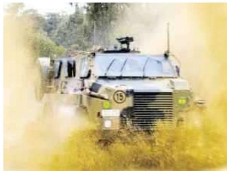
Машина Bushmaster изготавливается из несущего цельносварного стального корпуса высокой прочности. Общая длина машины составляет 7,18 м, ширину 2,48 м и высоту 2,65 м. Колесная база 3,9 м при колее 2,1 м.
