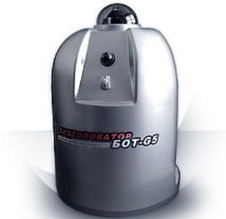
Российская компания Стилсофт представила новый роботизированный комплекс "Видеолокатор-Бот G5". Робот осуществляет круговой обзор при помощи четырех цветных видеокамер.
