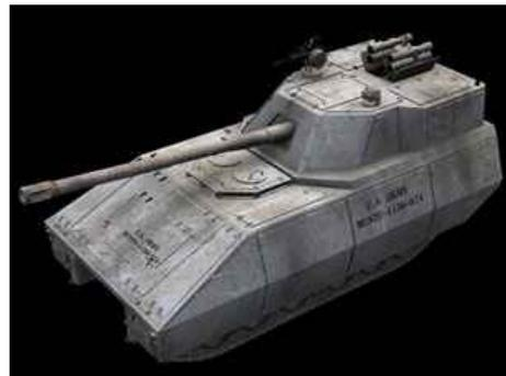
Mounted Combat System (MCS). Боевая машина, представляющая собой смесь танка с самоходной артиллерийской установкой. Ее задача - обеспечивать поддержку наступающих подразделений, уничтожать военные объекты, бронетехнику противника, подавлять огневые точки. Он будет действовать как в зоне прямой видимости, так и из укрытий. MCS должен обладать высокой мобильностью, огневой мощностью, повышенной бронезащитой.
