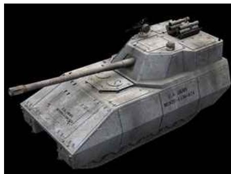
Mounted Combat System (MCS). Боевая машина, представляющая собой смесь танка с самоходной артиллерией установкой. Ее задача - обеспечивать поддержку наступающих подразделений, уничтожать военные объекты, бронетехнику противника, подавлять огневые точки. Он будет действовать как в зоне прямой видимости, так и из укрытий. MCS должен обладать высокой мобильностью, огневой мощью, повышенной бронезащитой.
