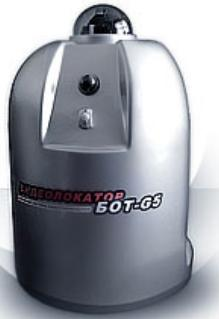
Российская компания Стилсофт представила новый роботизированный комплекс "Видеолокатор-Бот G5". Робот осуществляет круговой обзор при помощи четырех цветных видеокамер.
