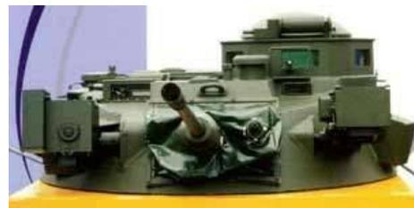
Южноафриканская компания Denel Land Systems (DLS) расширила боевые возможности своих башен LCT20 в дневных и ночных условиях путем интеграции передовых оптико-электронных прицельных комплексов как для командира, так и для наводчика. Эта башня может быть интегрирована в широкий спектр боевых бронированных машин.
