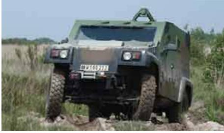
PVP (Petit Véhicule Protégé — Малая бронированная машина), бронированная четырехколесная полноприводная машина, которая может быть оснащена 7,62-мм пулемет на боевом модуле с дистанционным управлением.
