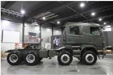
Известная шведская автомобильная компания Scania, которая выпускает семейство военных грузовиков, разработала инновационное решение для применения в армии — тяжелый колесный полноприводный тягач Scania R 730 8x8, который со специальным прицепом может использоваться в качестве танкового транспортера.
